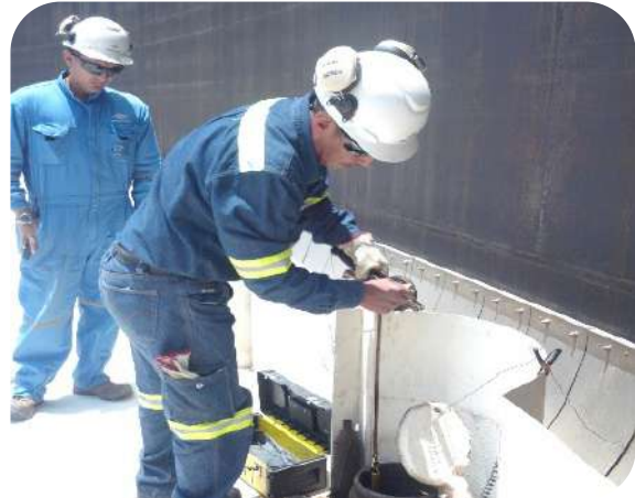
Imagen N°6: Refinería Gualberto Villarroel - Medición de volumen - 1TK 2901
