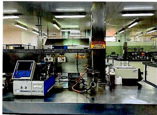
Imagen N° 6: Refinería Guillermo Elder Bell – Medidor de Punto de Inflamación LS – E030
